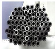
図-1 結束された小径管の例
