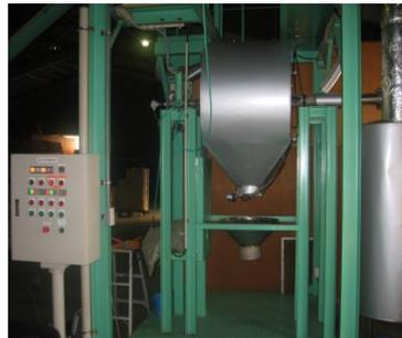
加熱空気乾燥機用制御器（PLC）
