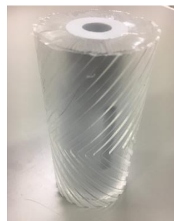
溝付きローラーの透明模型
