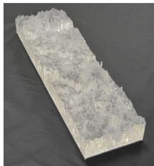
研磨パッド表面の透明模型
