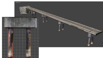
写真-2 3 次元形状取得による 構造物の変形の定量化
