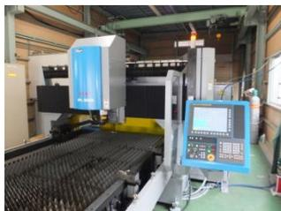
炭酸ガスレーザー加工機
